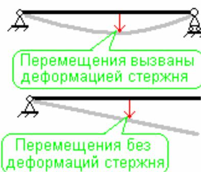
Рис.4.4 Примеры геометрически неизменяемой (сверху) и геометрически изменяемой (снизу) систем
